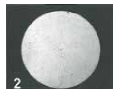
金屬切削面以半球形光源照明效果
