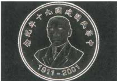
水平徑向環形光源照明效果
